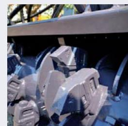
Rotor avec profils en acier (DCR) pour les deux types d'outils
