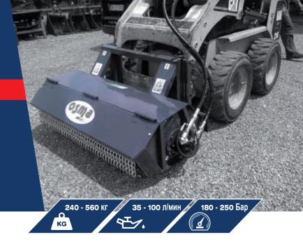
Косилка SS фронтальная на мини-погрузчик или компактный погрузчик со стандартным гидропотоком. Разработана специально для скоса травы, зарослей и кустов, для уборки территорий в парках и небольших насаждений, а также вдоль придорожной полосы. Специальная конструкция гарантирует превосходный результат удаления растительности. Максимальный диаметр среза 5см. Для носителей весом 0,65-2,0тн.
